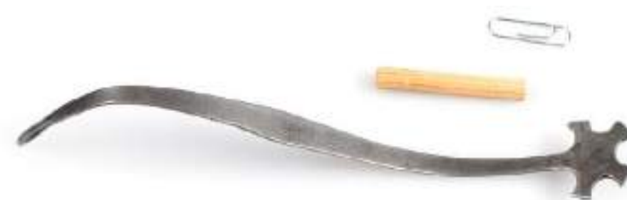
Vijoles dvēselīte un instruments tās ievietošanai gatavajā vijoles korpusā. RTMM, jaunieguvumi
