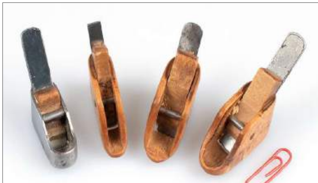
Mārtiņa Zemīša pašdarinātās ēvelītes vijoles vāku velvējuma izstrādāšanai. Ap 1928. gadu. RTMM, jaunieguvumi
